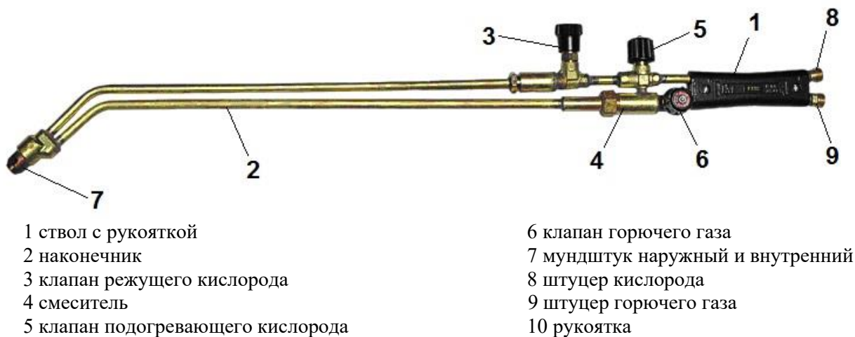
Рис. 1 Резак РЗПсб (L=800; 1000 мм)
