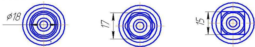
**Рис.2 Геометрические формы гнезд клапанов и штукеров (механическая кодировка)**
